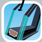
Стеклопакет L3: створка – «глухая», внешнее стекло – закаленное с легкоочищающимся покрытием, внутреннее стекло – ламинированное (ударостойкая система «триплекс»), теплая дистанционная рамка TGI
